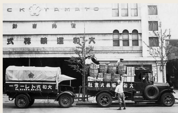
トラックに引かれて荷物を運ぶ大和式トレーラー(左:本社前での積荷、下:ブレーキ係が同乗した大和式トレーラー)
